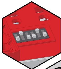
玩家可调整拨位开关来预设移动模式，当传感器被触发时，蚂蚁机器人将按设定的模式进行移动。一共有64种不同编程供您选择！
