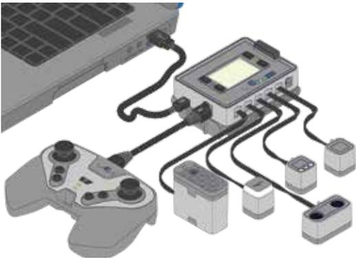
将所有元件与机器人主控器连接，然后使用USB线连接主控器与电脑。
